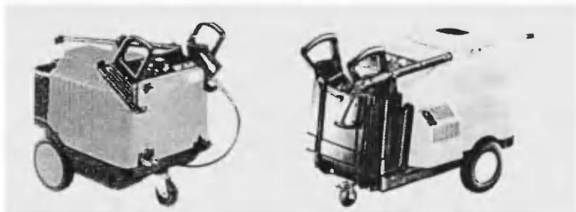
Рис. 3.3.2. Передвижные установки для мойки автомобилей
