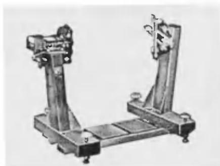
Рис. 3.5.2. Стенд для разборки-сборки двигателей легковых автомобилей
